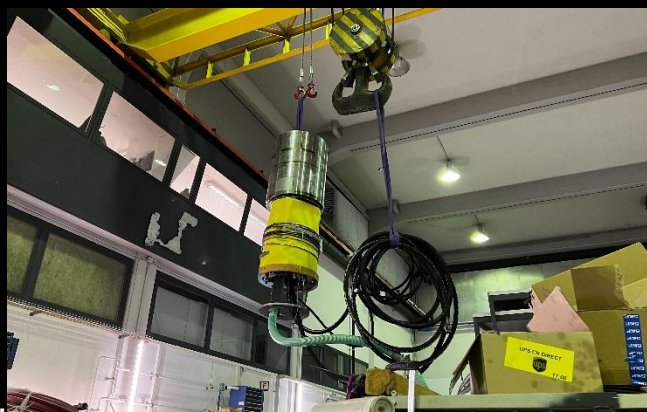
Erosions- und Steuerungs-Subsystem transportiert mittels unserem 25t-Kran
