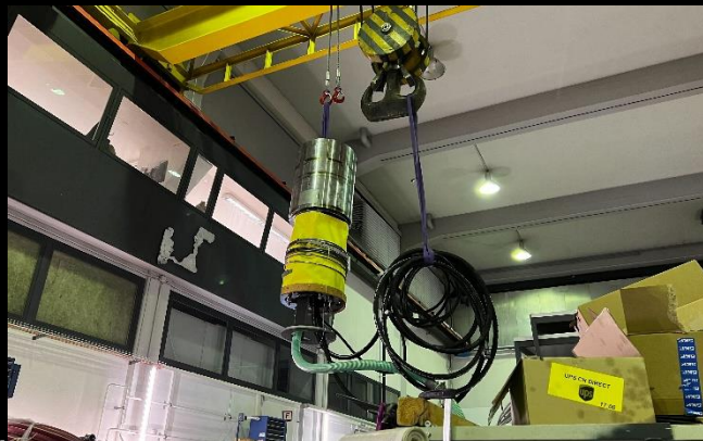
Erosions- und Steuerungs-Subsystem transportiert mittels einem 25t-Kran
