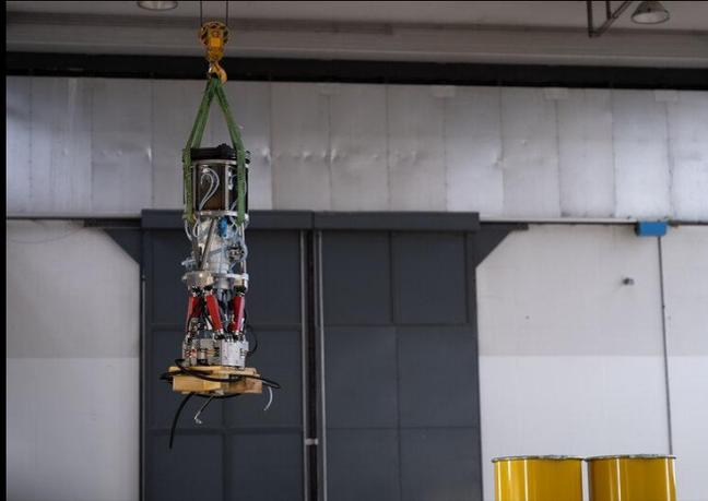
*Erosions- und Steuerungs-Subsystem transportiert mittels unserem 25t-Kran*
